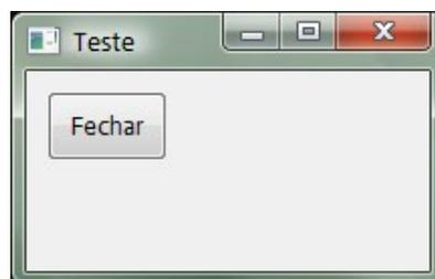
Um dos maiores atrativos do PyQt é o *GUI Builder* (ferramenta para a construção de interfaces) Qt Designer. Os arquivos XML gerados pelo Qt Designer (com a extensão `.ui`) podem ser convertidos em módulos Python através do utilitário `pyuic`.
